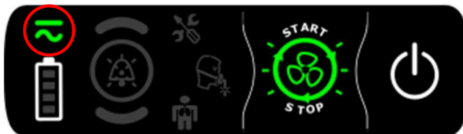
Respiratorns indikatorskärm – Strömförsörjning från EO-
