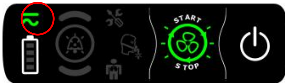
Teclado Ventilador - Ventilador alimentado por el EO-BAT9
